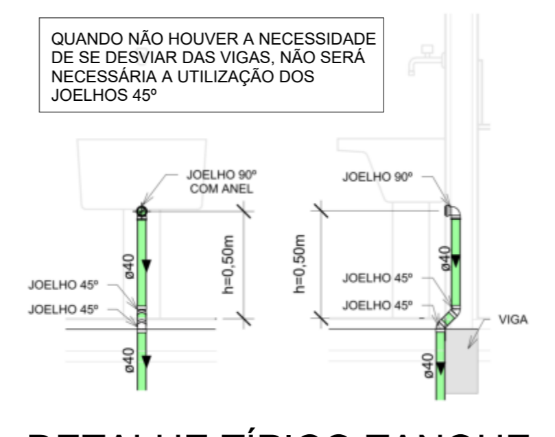
DETALHE TÍPICO TANQUE
